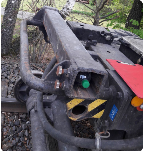
Angebrachte 4 Kant-Führungen zum Arbeiten neben dem Gleis
