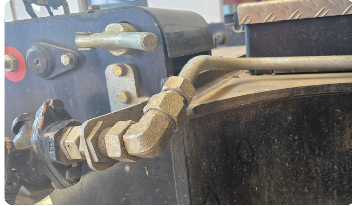
Verbogene Bremsleitung der Wagonbremse
