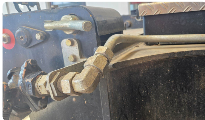
Verbogene Bremsleitung der Wagonbremse
