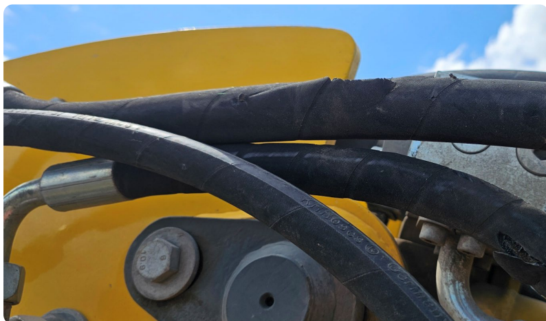
Lose Hydraulikschläuche an dem Ausleger von Liebherr A922 Baggern führen zu beschädigten Hydraulikschläuchen
