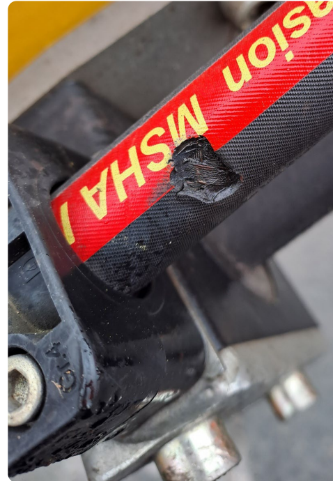
Beschädigte Hydraulikschläuche am Bagger Ausleger
