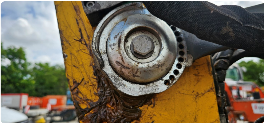
Abgerissene Schraube am Drehwinkelgeber
