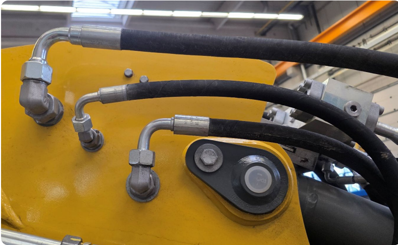
Lose Hydraulikschläuche an dem Ausleger von Liebherr A922 Baggern führen zu beschädigten Hydraulikschläuchen
