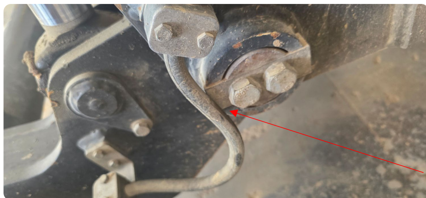
Bei falsch verlegten Bremsleitungen reibt diese am Achsbolzen und wird beschädigt
