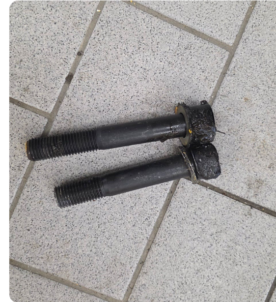
Vergleich Abgerissene (untere) zur normalen Schraube (oben)
