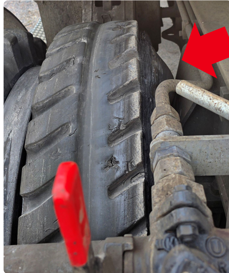
Kann bei Druckveränderungen des Reifens mit dem Unterwagen kollidieren Achtung kann zu Verweigerung Plakette führen
