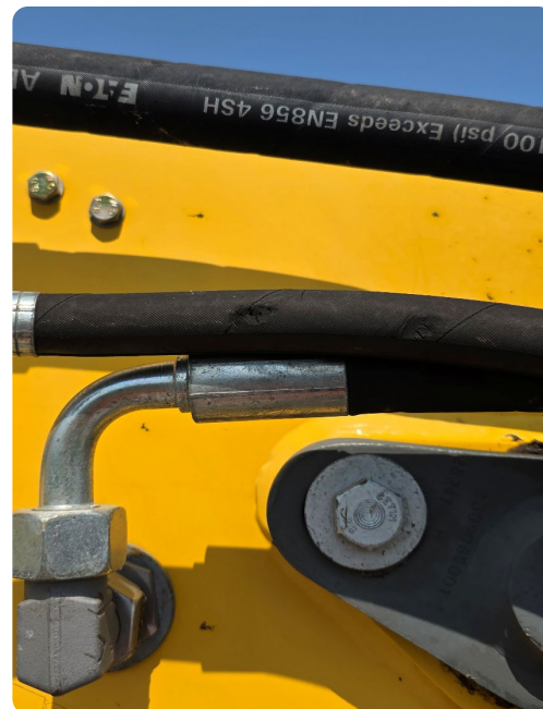
Bei falscher Verlegung der Hydraulikschläuche reiben die Schläuche aneinander und werden so Beschädigt
