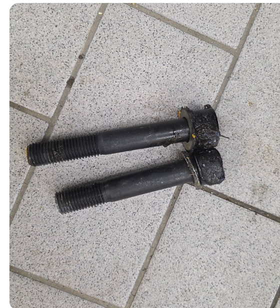
Vergleich Abgerissene (untere) zur normalen Schraube (oben)
