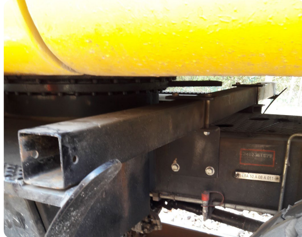
Angebrachte 4 Kant-Führungen zum Arbeiten neben dem Gleis
