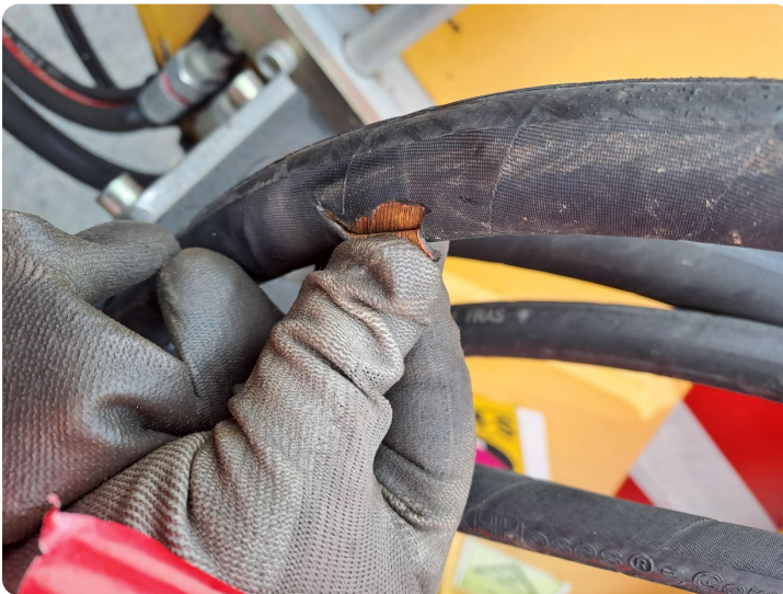
Beschädigte Hydraulikschläuche am Bagger Ausleger
