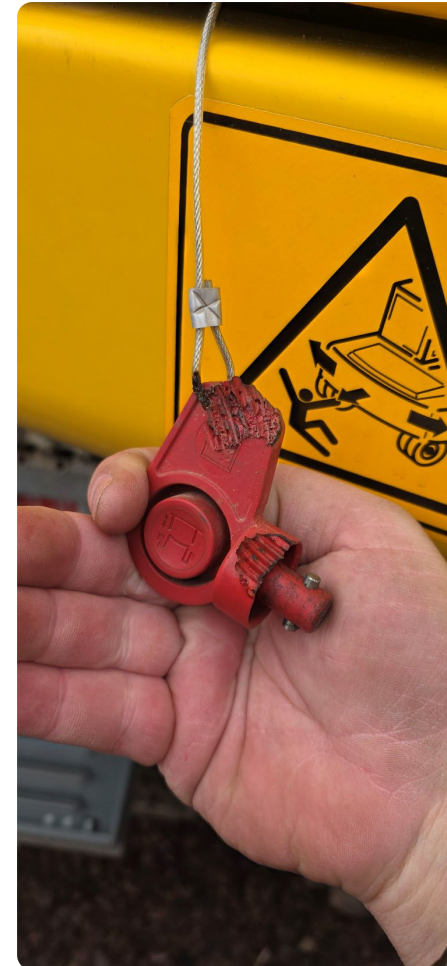
Verbrannter Knochen, da dieser nicht in die vorgesehene Halterung gesteckt wurde
