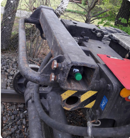
Angebrachte 4 Kant-Führungen zum Arbeiten neben dem Gleis
