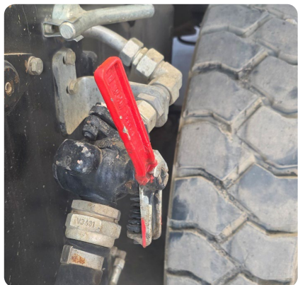
Verbogene Bremsleitung der Wagonbremse
