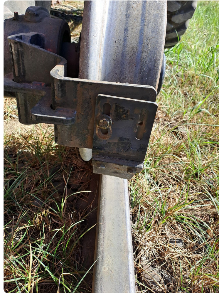
Abgerissene Schraube und verbogener Schienenräumer
