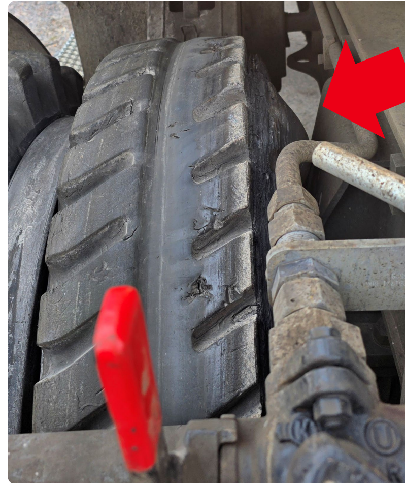
Kann bei Druckveränderungen des Reifens mit dem Unterwagen kollidieren Achtung kann zu Verweigerung Plakette führen
