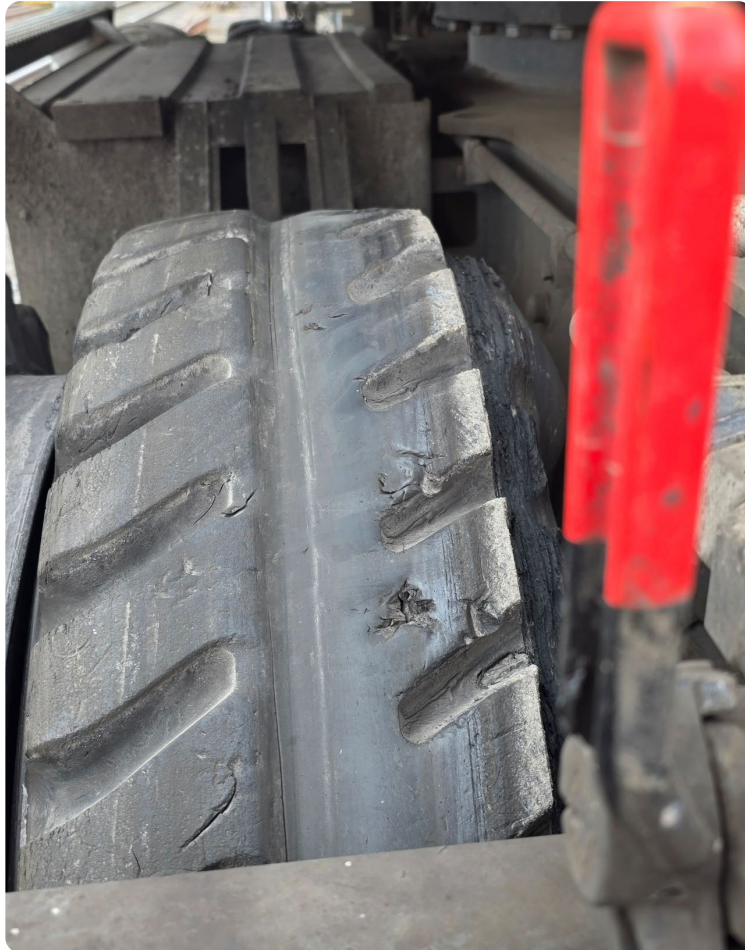
Karkassenbruch des inneren Reifens
