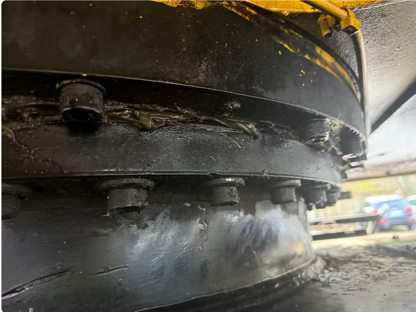
Abgerissene Schrauben zwischen Ober.- und Unterwagen
