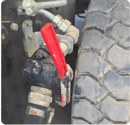
Verbogene Bremsleitung der Wagonbremse
